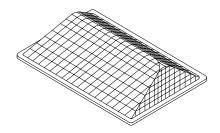
BOROSILICATE MOLDED GLASS, GASKET
